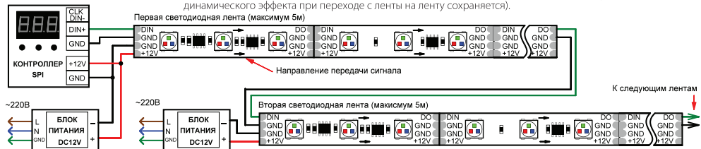
Рис.2. Схема подключения ленты при управлении от внешнего контроллера.
